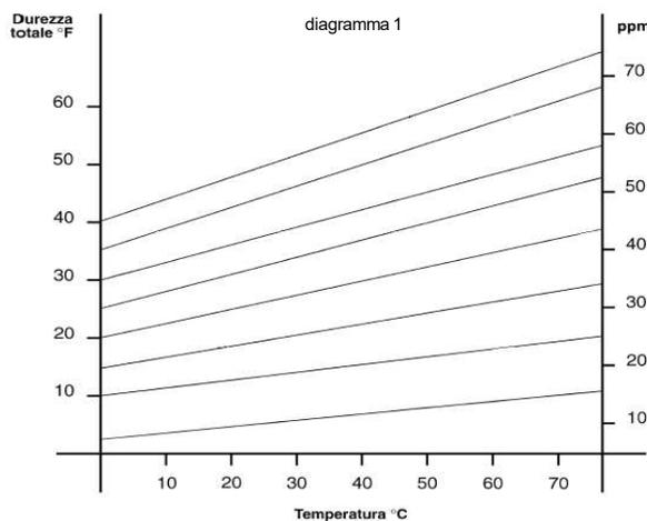
**MODALITA' D'USO:** Iniettare nell'impianto mediante pompa volumetrica o proporzionale. Impostare il dosaggio in funzione della durezza totale dell'acqua da trattare e la sua temperatura (vedi diagramma 1). Il contenuto nell'acqua del principio attivo è verificabile come  $P_2O_5$  attraverso l'utilizzo dei Kit Fosfati
